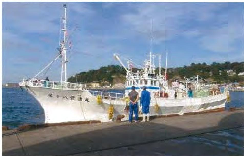
図 7 53t 従来型沖合底曳網漁船
