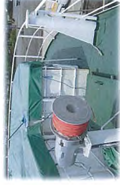
(トリポール設置台と巻取りリール)
