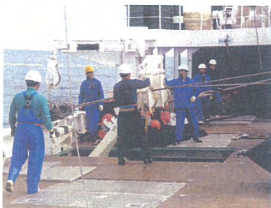
③環ワイヤーの巻込み終了と環の取込み（網裾は絞り込んだ状態）
