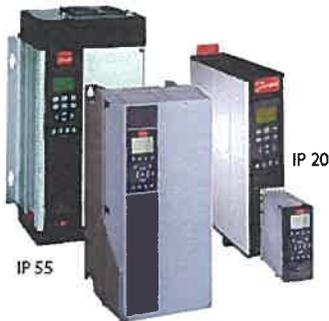
インバーター制御システムとは、冷凍装置の負荷特性により、電動機の回転数を変えることで動力が回転数の3乗に比例する事を踏まえて、インバータにより回転数を変更し、無駄な動力を削減する省エネルギーシステムです。
