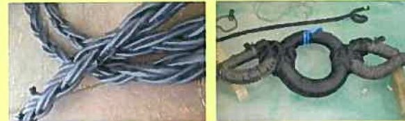
側張り：化繊ロープ 接続：ロープリングと化繊ロープ
