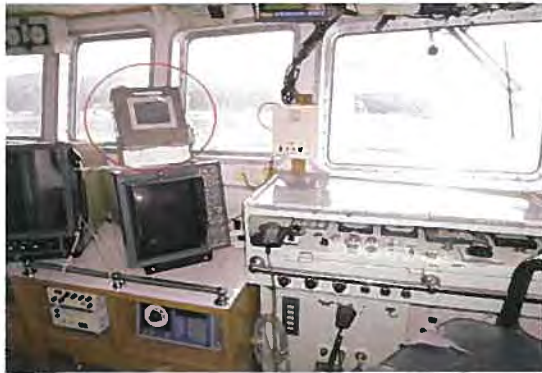
操舵室に設置された燃料消費モニター
