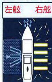
②左舷側の漁灯を消し右舷側は点灯したまま、サンマを右舷側に誘導します。その間に左舷側に網を入れます。
