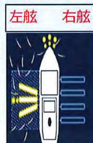
③船首と左舷側の漁灯を点灯し、右舷側の漁灯を船尾から順番に消してサンマを網の方に誘導します。
