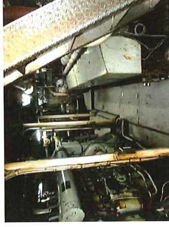
現行船機関場 (135トン型) 天井が低く、通路が狭いため 複数人での作業が困難
