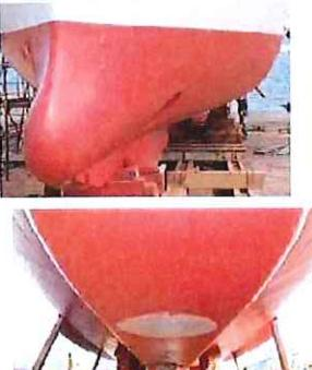
船体とプロペラをあわせて清掃することで、水の抵抗を軽くする効果が大きくなり、結果、燃油削減率は最大で約22%の効果が得られる。
