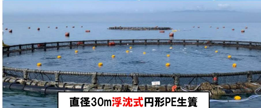
直径30m浮沈式円形PE生簀
