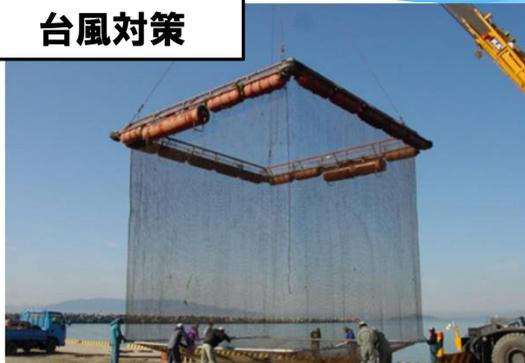
10m角型浮沈式鉄生簀
