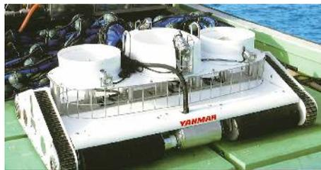
3連式大型網洗浄ロボット
