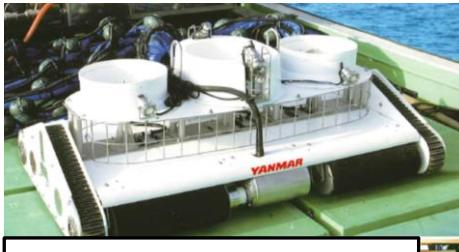
3連式大型網洗浄ロボット
