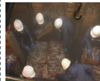
①魚倉内でのパレットへの木箱の積み上げ作業
