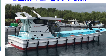
19トン型高性能EP給餌船 (R4.9進水)
