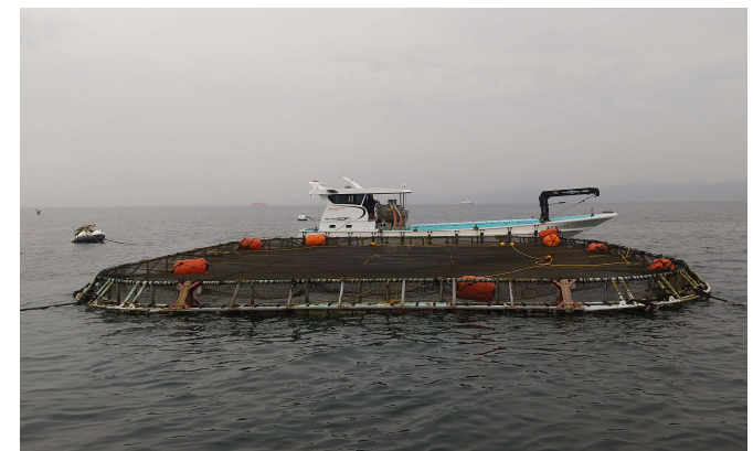
本事業で導入した浮沈式大型銅金網生簀
