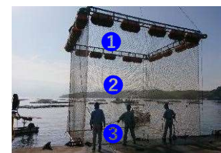
浮上式8m銅金網生簀の銅線耐久試験（開始R1.1月～終了R3.10月）
