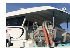
破損が少ない EPエア搬送機
