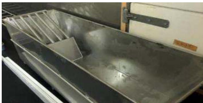
改良型グレーズタンク（気仙沼スロープ）の採用
