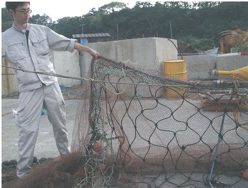
仕切網上端に取り付けた吊りロープ
