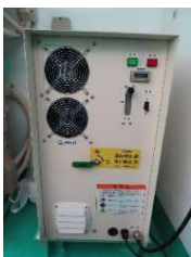
高性能活魚設備 (酸素供給装置)
